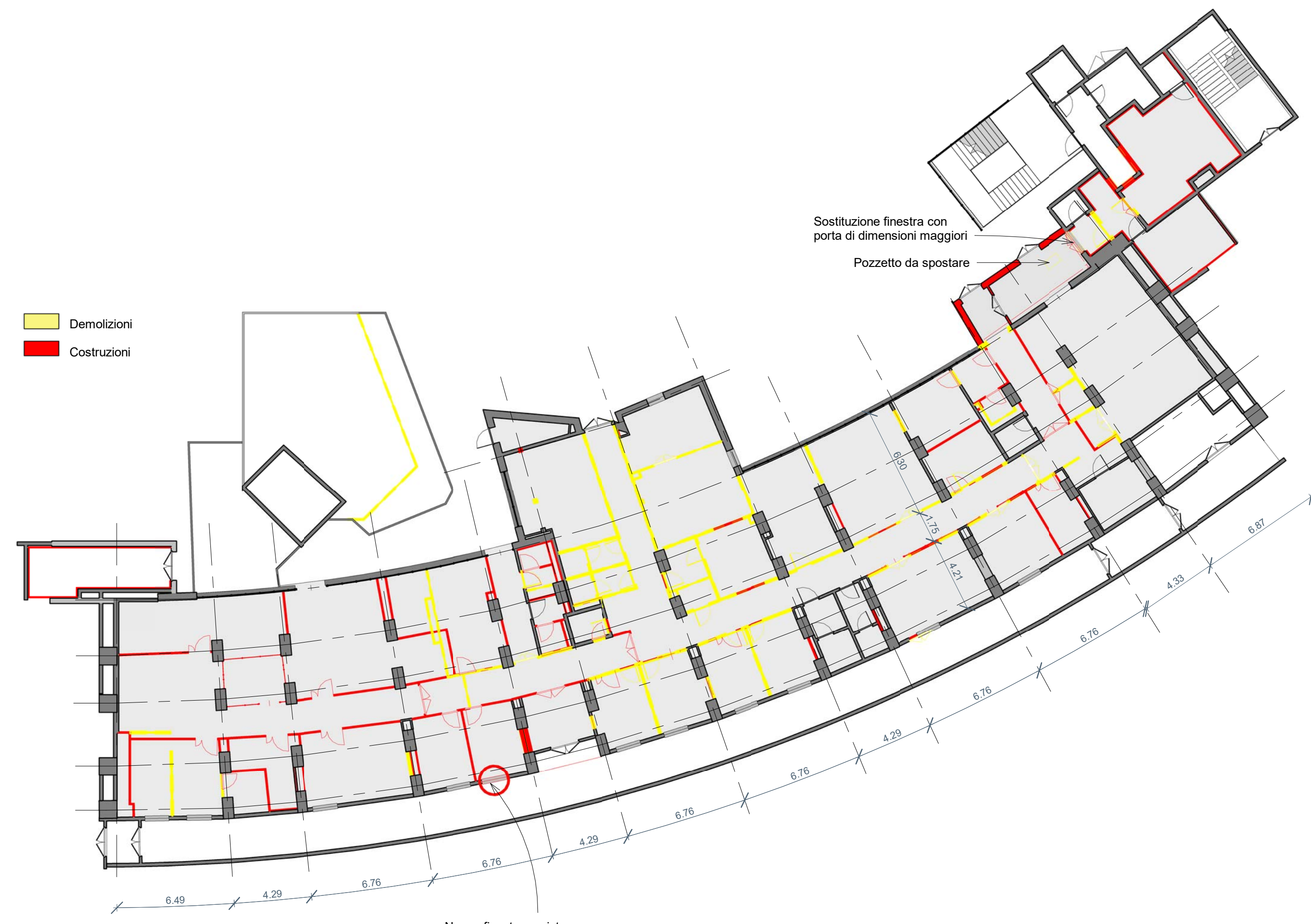
PIANTA DELLE DEMOLIZIONI E COSTRUZIONI - SCALA 1:200
